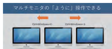
図5：仮想デスクトップを使えば、マルチモニタと同じ効果が実現できる
